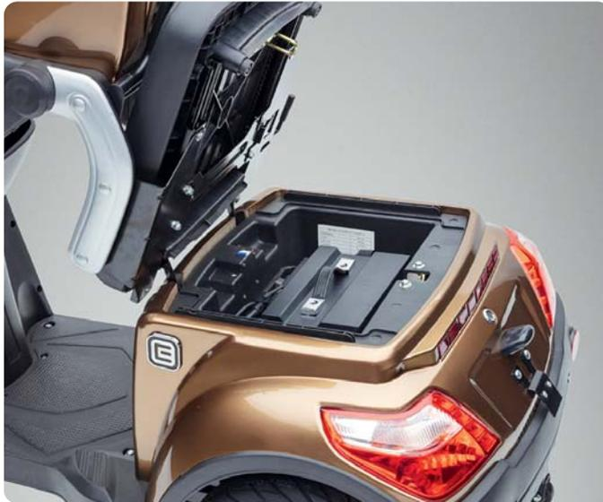
Abb. 1.9 Dieses Fahrzeug ist optional auch mit entnehmbaren Lithium-Akku erhältlich.
