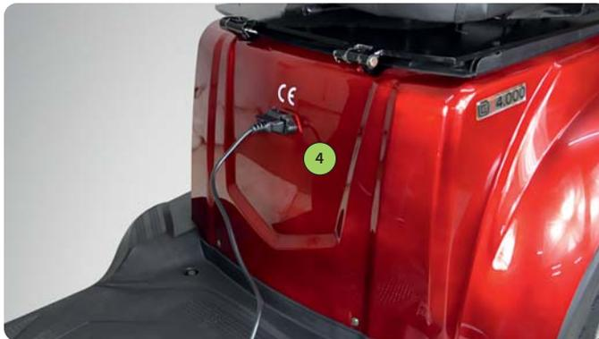
Abb. 1.11 Die Ladebuchse und Original-Ladekabel
