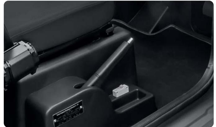
Abb. 1.13 Handbremse
