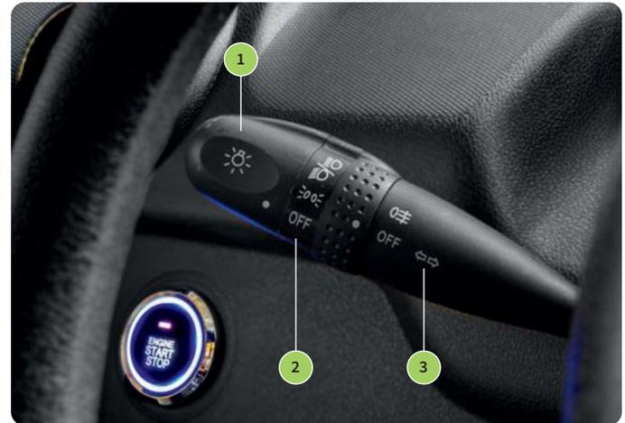
Abb. 1.17 Hebel für Beleuchtung
