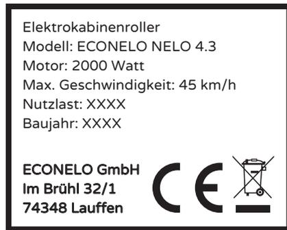
Abb. 1.1 Beispielbild für Typenschild
