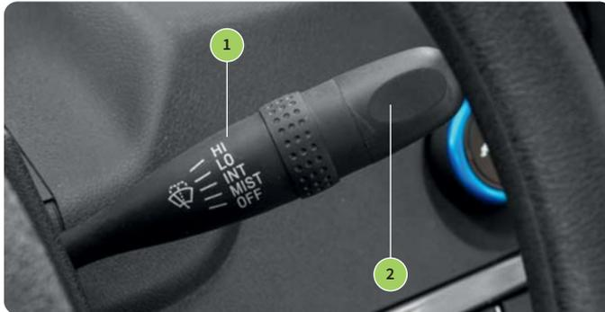
Abb. 1.18 Hebel für Scheibenwischer
