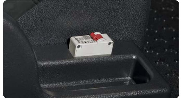
Abb. 1.19 Hauptsicherung
