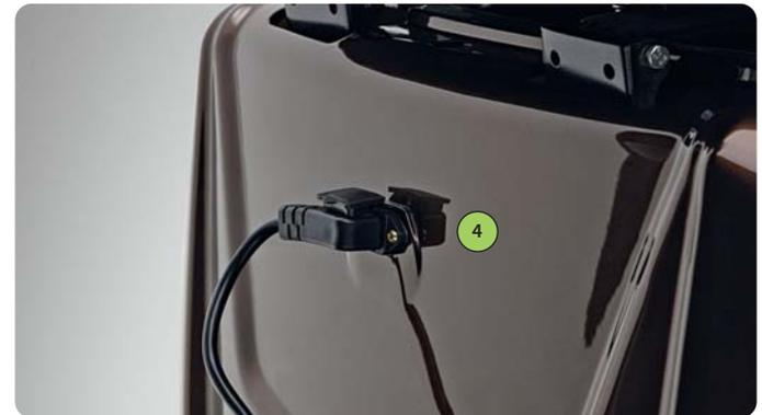
Abb. 1.10 Die Ladebuchse und Original-Ladekabel
