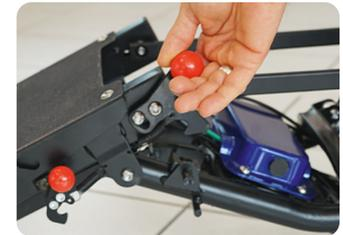
3. Verriegelung mit dem Sicherungshebel (ausgeklappt) (Pos. 1) lösen.
