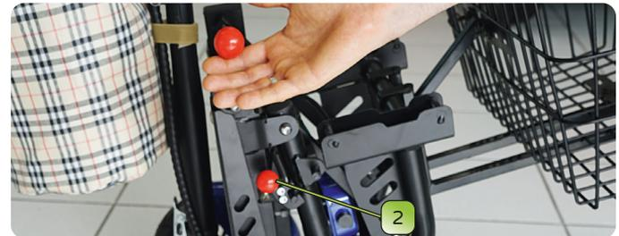
5. Sicherstellen, dass der Sicherungshebel (eingeklappt) (Pos. 2) in Endposition vollständig einrastet.
