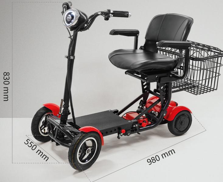
*Min. Fahrzeuggröße, zusammengeklappt*
