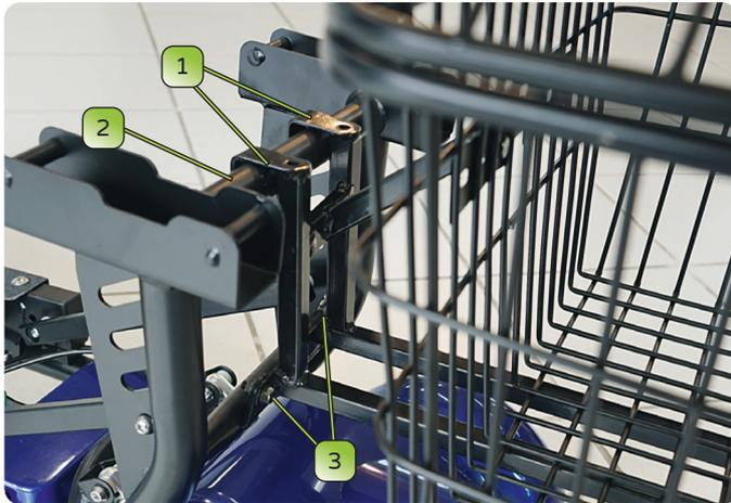
1. Korbhalterung (Pos. 1) auf der Korbauflage (Pos. 2) einhängen und so ausrichten, dass die Gewindelöcher (Pos. 3) der Korbes und der Korbauflage übereinanderliegen.
