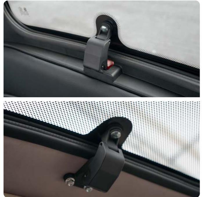
Abb. 1.22 Verriegelung und Öffnen von Heckfenster (oben) und Dachluke (unten)
