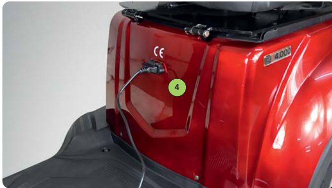
Abb. 1.11 Die Ladebuchse und Original-Ladekabel
