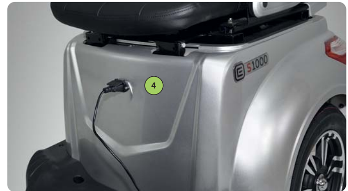
Abb. 1.10 Die Ladebuchse und Original-Ladekabel
