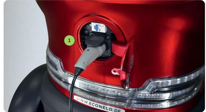
Abb. 1.16 Ladebuchse mit Original-Ladekabel
