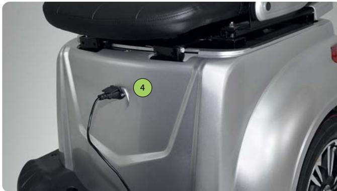
Abb. 1.11 Die Ladebuchse und Original-Ladekabel
